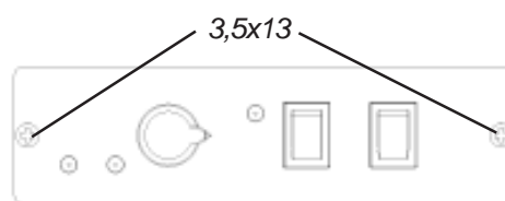
Kuva 5: 86D:n ohjauspaneelin kiinnittäminen pöytään.
